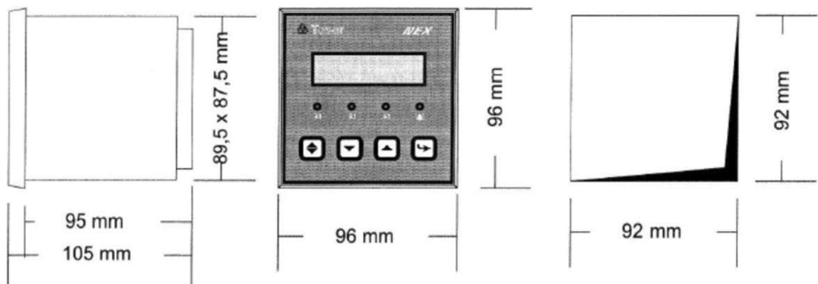
Рисунок 3. Габариты устройства
