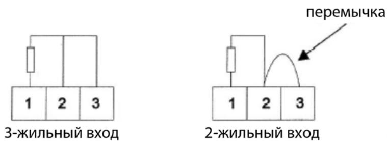
Рисунок 5. Схема подсоединения проводов
